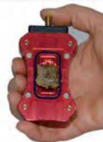
Portador de sección delgada con sistema de succión patentado
