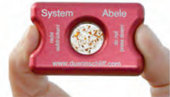
Portador de sección delgada con ventana de inspección
