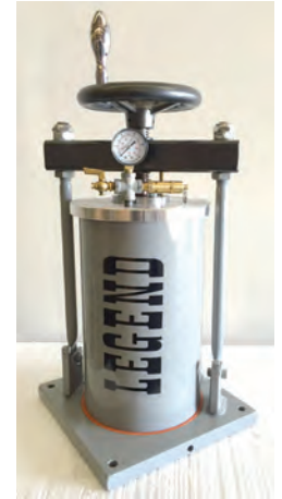
Filtros a presión
